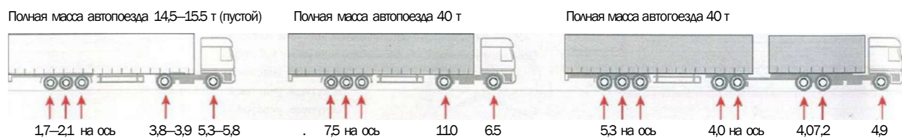
Примеры нагрузок на оси в тоннах для автопоездов, по данным Авторевю и немецких транспортных компаний. Слева — стандартный пустой автопоезд длиной 16,5 м. в центре — полностью груженный. Справа — «паровоз» длиной 25,25 м, но тоже полной массой 40 т (такие проходят испытания в Германии); у такой комбинации нагрузки на оси резко снижаются
